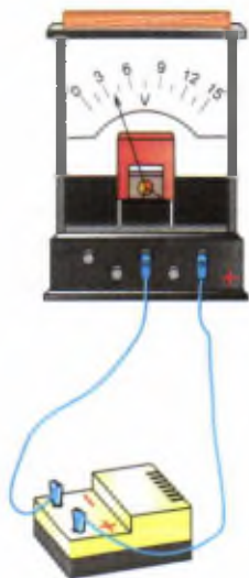
Рис. 67. Подключение вольтметра к источнику тока
