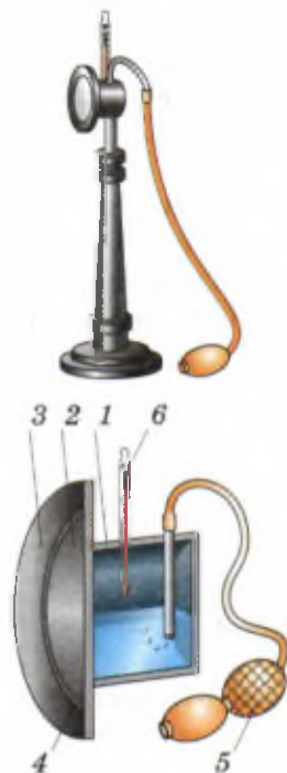
Рис. 23. Внешний вид и устройство конденсационного гигрометра
