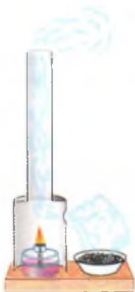
Рис. 11. Модель для демонстрации тяги
