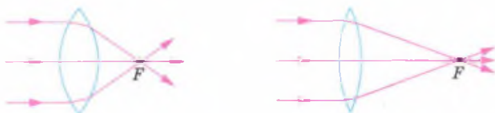
Рис. 155. Преломление лучей линзами различной кривизны
