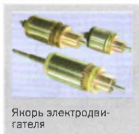
Рис. 119. Схема якоря двигателя
