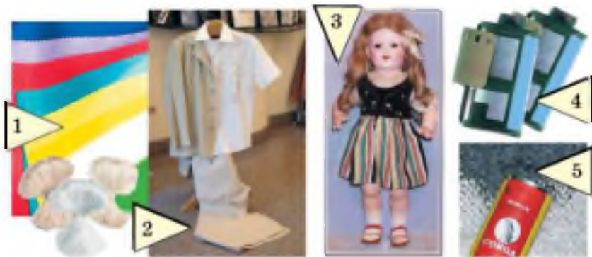
Рис. 3. Изделия и материалы, изготовленные на основе искусственных органических соединений: 1, 2 — искусственные волокна и ткани; 3 — пластмасса (целлулоид); 4 — фотоплёнка; 5 — бездымный порох
