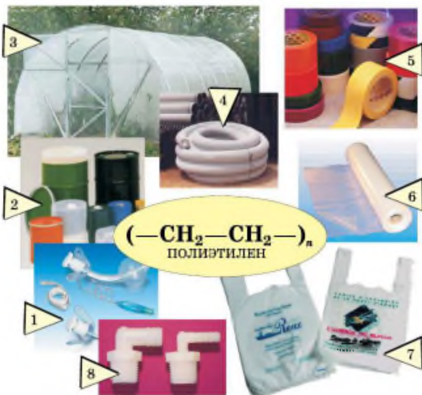
Рис. 16. Применение полиэтилена: 1 — медицинское оборудование; 2 — предметы домашнего обихода; 3 — плёнка для парников; 4 — трубы и фитинги; 5 — клейкая лента; 6 — упаковочная плёнка; 7 — пакеты; 8 — детали
