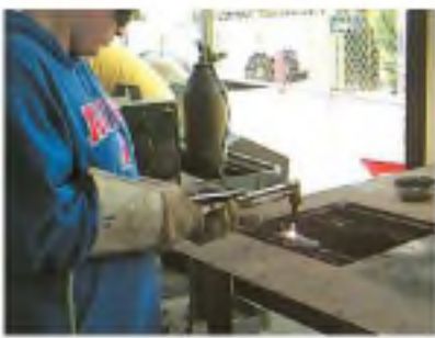
Рис. 22. Ацетиленокислородное пламя используют для режки и сварки металла
