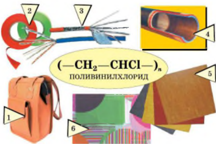
Рис. 23. Применение поливинилхлорида: 1 — искусственная кожа; 2 — изолента; 3 — изоляция проводов; 4 — трубы; 5 — динолеум; 6 — клеёнка
