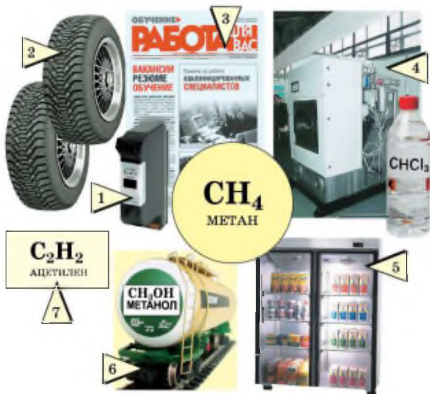
Рис. 13. Применение метана: 1—3 — производство сажи (картриджи 1, резина 2, типографская краска 3); 4—7 — получение органических соединений (растворителей 4, хладагентов (фреонов), используемых в холодильных установках, 5, метанола 6, ацетилена 7)
