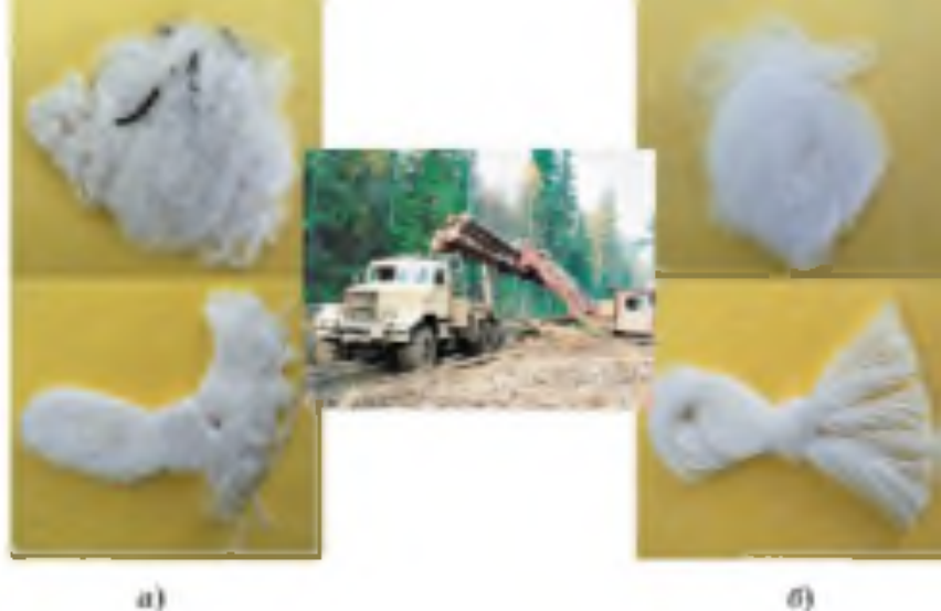
Рис. 43. Вискозное (а) и ацетатное (б) волокна — это искусственные волокна, их получают путём химической модификации природных органических полимеров
