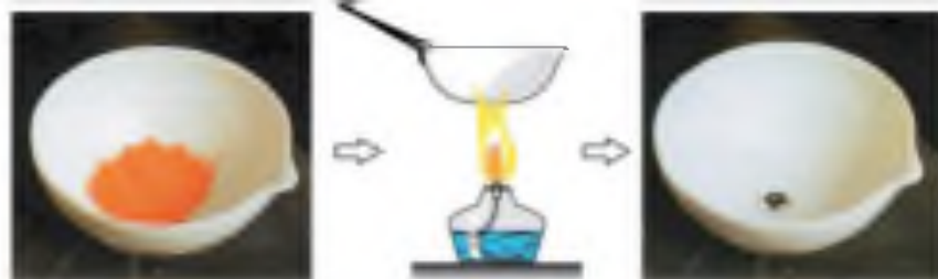
Рис. 94. Получение кислорода разложением оксида ртути
