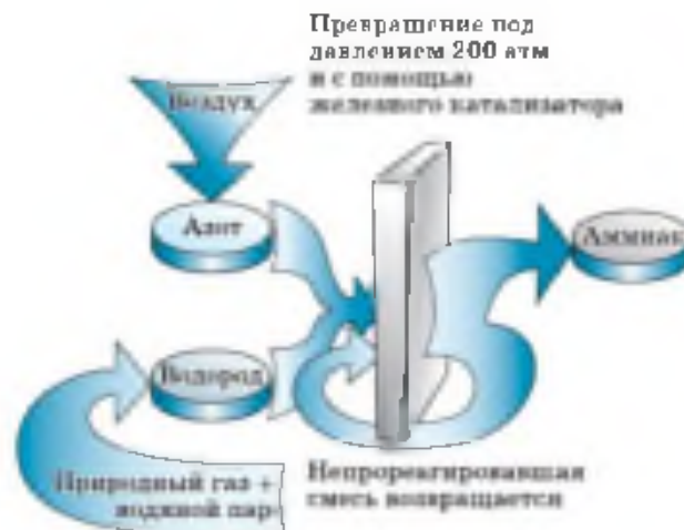
Рис. 107. Схема промышленного получения аммиака
