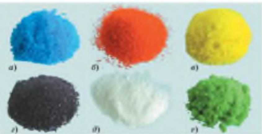
Рис. 137. Соли имеют самые различные цвета: а — медный купорос; б — дихромат калия; в — жёлтая кровяная соль; г — перманганат калия; д — хлорид натрия; е — нитрат никеля (II)
