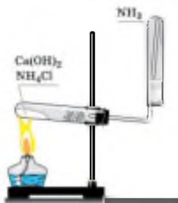
Рис. 64. Лабораторный способ получения аммиака
