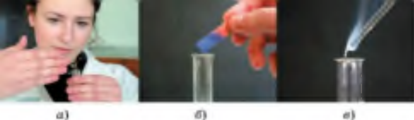
Рис. 65. Распознавание аммиака: а — по запаху; б — по изменению окраски индикаторной бумажки; в — по появлению дыма при поднесении стеклянной палочки, смоченной соляной кислотой
