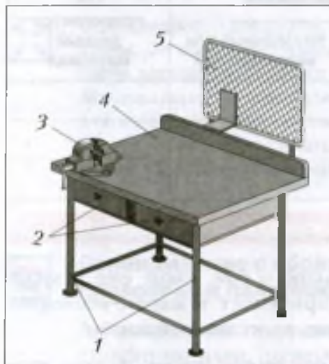
Рис. 92. Слесарный верстак: 1 – основание; 2 – ящики для инструментов; 3 – тиски; 4 – крышка; 5 – защитная сетка
