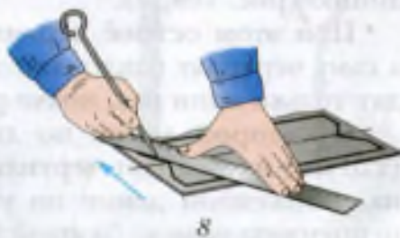
Рис. 109. Последовательность разметки детали из тонколистового металла (1–8)
