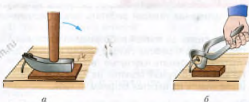
Рис. 51. Приёмы вытаскивания гвоздей: а – молотком; б – клещами
