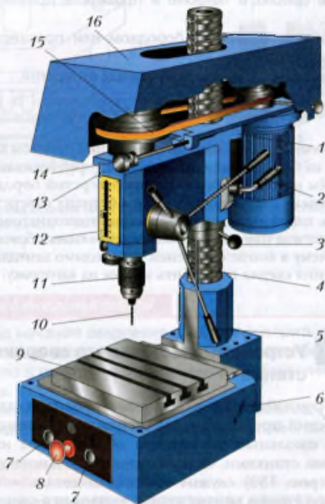
Рис. 139. Устройство сверлильного станка: 1 – шпиндельная бабка с электродвигателем; 2 – ручка фиксирования шпиндельной бабки; 3 – рукоятка подъёма и опускания шпиндельной бабки; 4 – винтовая колонна; 5 – рукоятка подачи шпинделя с патроном; 6 – станина; 7 – кнопки включения; 8 – кнопка выключения; 9 – стол; 10 – сверло; 11 – патрон; 12 – шкала установки глубины сверления; 13 – шпиндельная коробка; 14 – винт натяжения ремённой передачи; 15 – ремённая передача; 16 – кожух ремённой передачи
