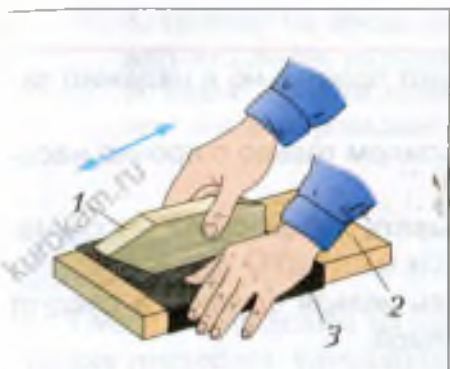
Рис. 62. Шлифование детали: 1 – деталь; 2 – подкладная доска; 3 – шлифовальная шкурка
