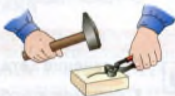
Рис. 53. Выпрямление согнутых гвоздей на бруске
