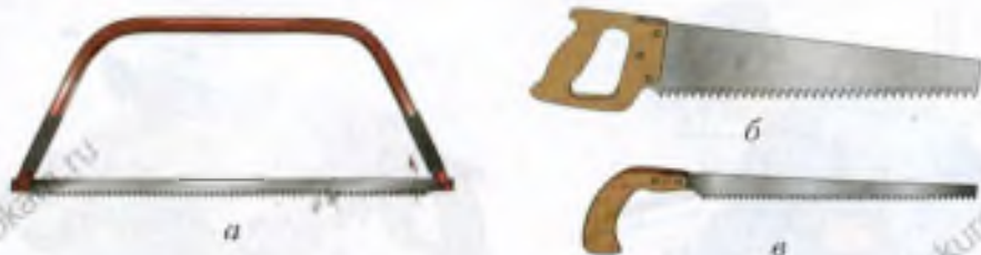
Рис. 23. Инструменты для пиления: a – лучковая пила; б – столярная ножовка; в – выкружная пила
