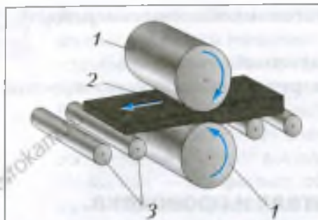
Рис. 88. Схема прокатки листового металла: 1 – валки; 2 – металлический лист; 3 – ролики
