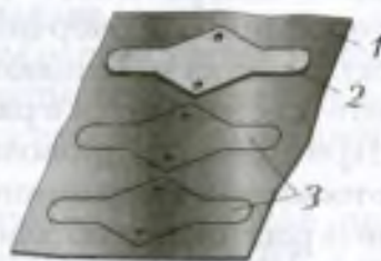
Рис. 110. Разметка деталей с помощью шаблона: 1 – заготовка (тонколистовой металл); 2 – шаблон; 3 – размеченные контуры деталей (крючков для вешалки)
