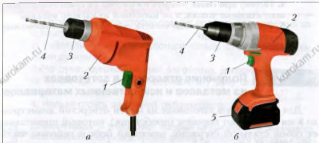
Рис. 134. Электродрель (а) и аккумуляторная дрель-шуруповёрт (б): 1 – кнопка включения; 2 – электродвигатель в корпусе; 3 – патрон; 4 – сверло; 5 – корпус с аккумулятором
