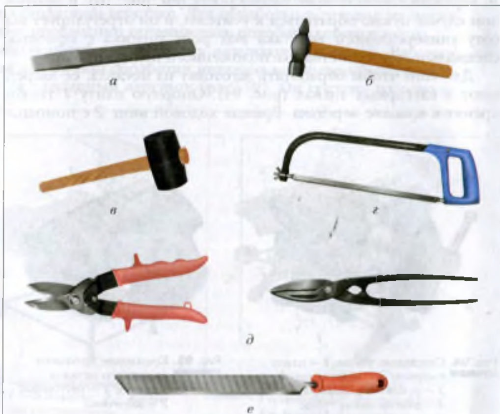
Рис. 96. Инструменты для ручной обработки тонколистового металла и проволоки: а – зубило; б – слесарный молоток; в – киянка; з – ножовка; д – ножницы по металлу; е – напильник
