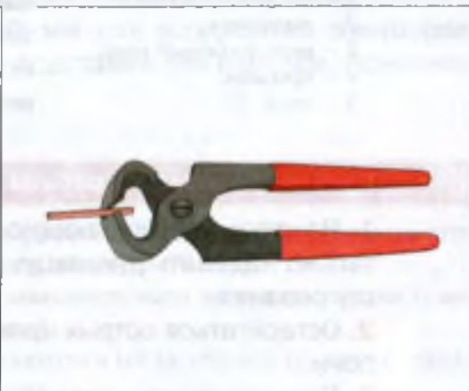
Рис. 116. Резание проволоки кусачками
