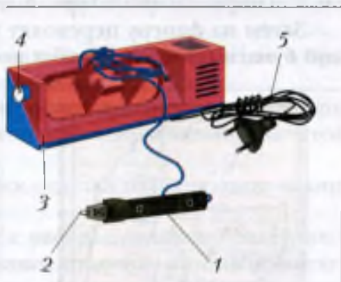
Рис. 73. Прибор для выжигания по дереву (электровыжигатель): 1 — рукоятка; 2 — наконечник; 3 — корпус; 4 — регулятор нагрева наконечника; 5 — электрический шнур
