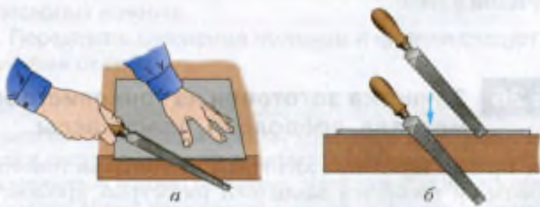
Рис. 119. Зачистка тонколистовой заготовки напильником: а — расположение заготовки; б — движения напильником
