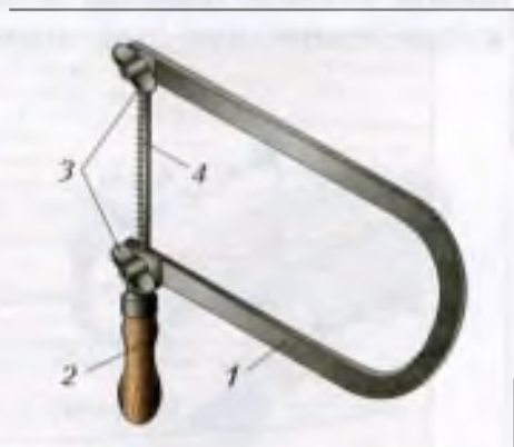
Рис. 68. Ручной лобзик: 1 – рамка; 2 – ручка; 3 – зажимные гайки; 4 – пилка
