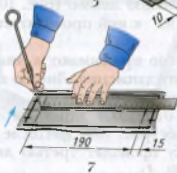
Рис. 109. Последовательность разметки детали из тонколистового металла (1–8)
