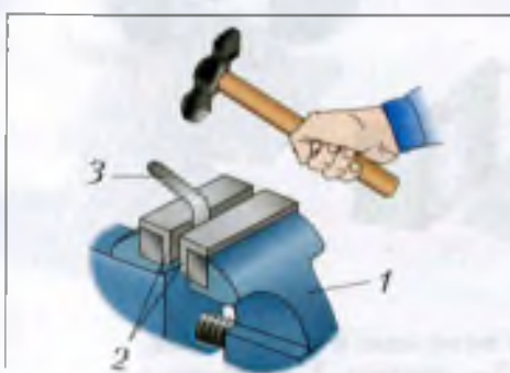
Рис. 130. Гибка толстой проволоки в тисках: 1 — губки тисков; 2 — уголки; 3 — заготовка
