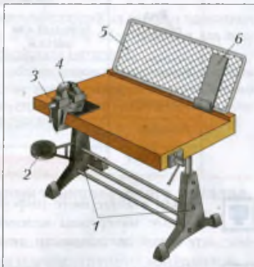
Рис. 93. Универсальный верстак: 1 – основание; 2 – сиденье; 3 – крышка; 4 – тиски; 5 – защитная сетка; 6 – подставка для технической документации
